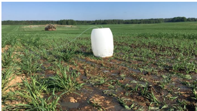
1. att. Amonjaka mērījumi ar „Picarro G2508” un 60 l mērījumu kameru.
